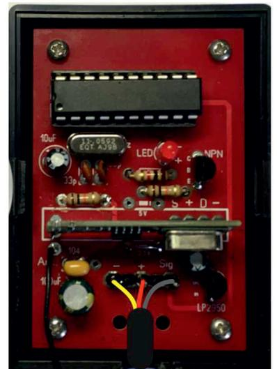
Die neue Platine ist ausgelegt für 433 Module mit 5 Volt oder auch 3 Volt Spannung.
